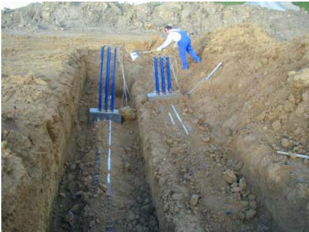
Bild 11: Karlsruhe Schertester während des Einbaus in der Rekultivierungsschicht
