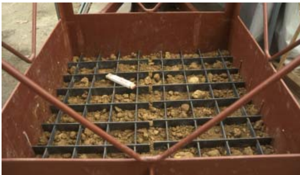
Bild 6: Blick in den Scherkasten des Rahmenschergerätes mit dem zusätzlich eingelegten Gitterrahmen zur flächigen Schubkrafteinleitung in die obere Probenhälfte (Probe noch nicht fertig eingebaut)
