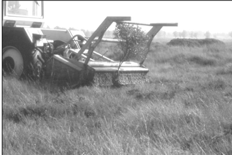
Abbildung 9: Einsatz eines Schlegelmulchers zur maschinellen Gehölzbeseitigung in der Senne (Foto: HARTEISEN 1989)
