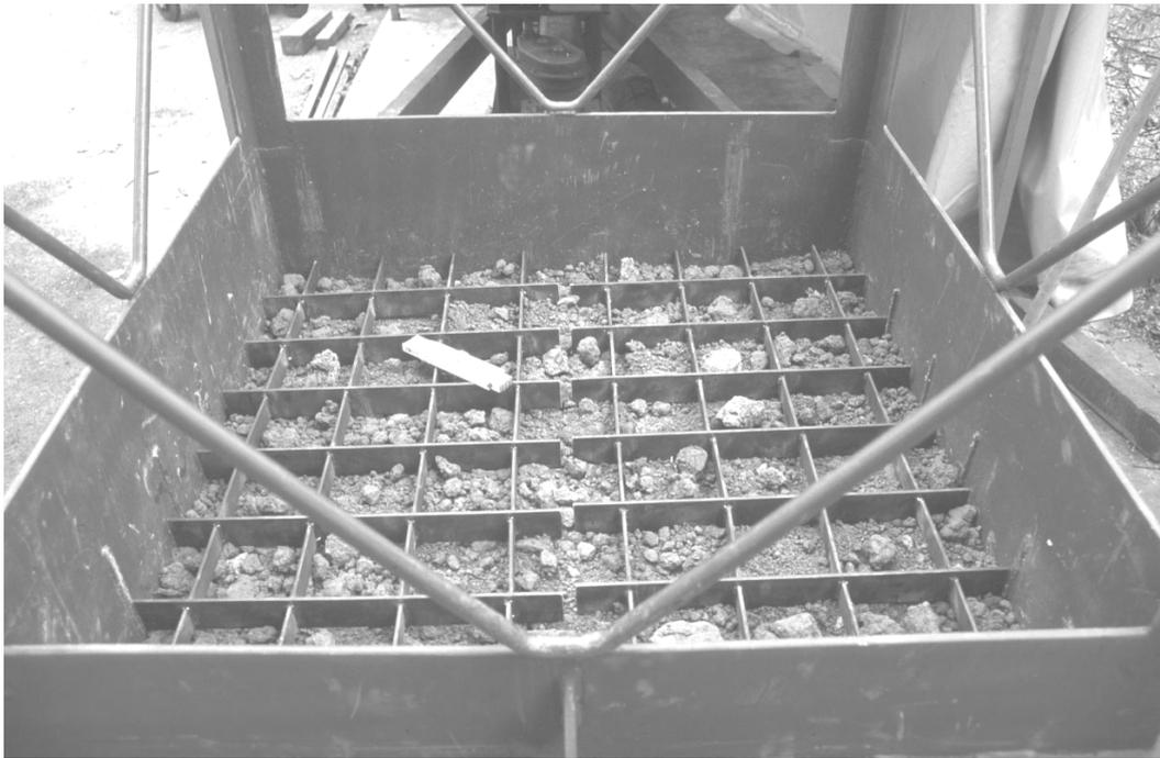
Bild 5: Blick in die Scherbox des Rahmenschergerätes mit dem zusätzlich eingelegten Gitterrahmen zur flächigen Schubkrafteinleitung in die obere Probenhälfte (Probe noch nicht fertig eingebaut)
