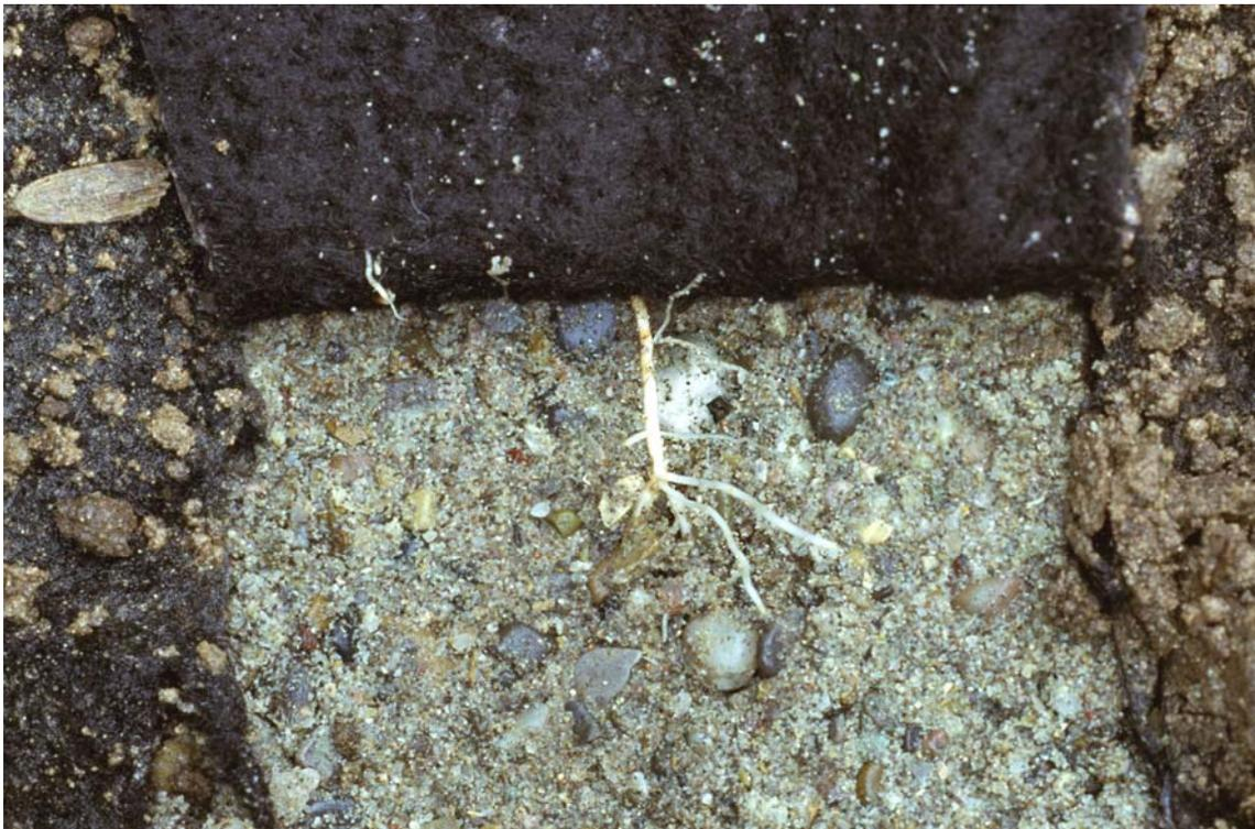
Bild 24: Eine Ampferwurzel hat die Kupfer-Wurzelsperrematte durchdrungen; die Matte ist aufgeschnitten, Ansicht von unten
