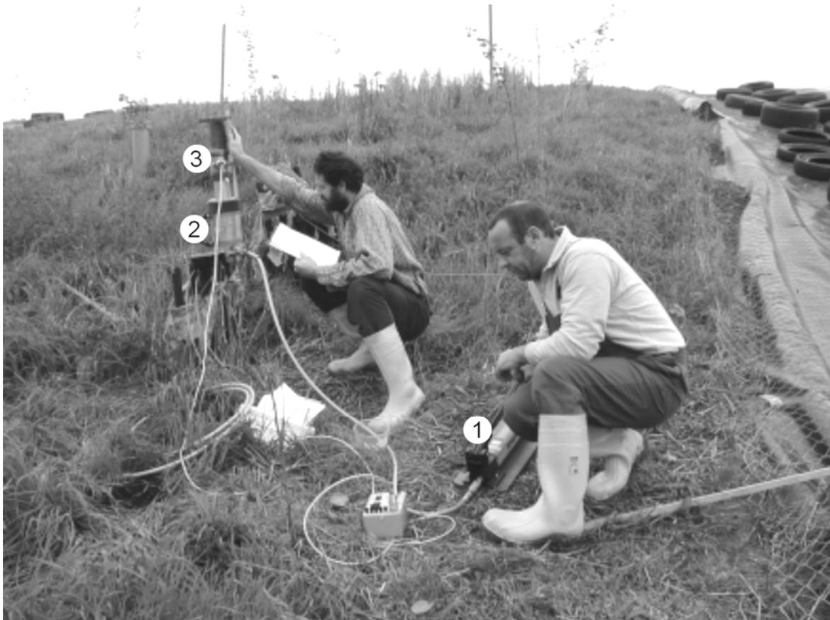
Bild 8: Durchführung eines in-situ-Scherversuches mit einem Karlsruher Schertester
