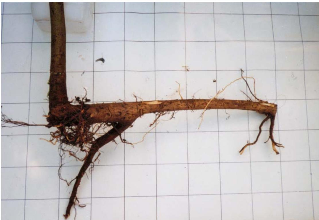
Bild 19: *Salix viminalis* aus einer 6-jährigen Buschlage (Deponie Hasenholz, Tuttlingen). Der Ast war nicht, wie für Buschlagen erforderlich, nach innen, gegen den Hang geneigt eingebaut, sondern mit einer Außenneigung von ca. 5°. Die typische Folge ist die schlechte Ausbildung der am Astende ansetzenden basalen Wurzeln. Dagegen wurde im vorderen Astbereich eine starke Stützwurzel entwickelt, die für die Böschungsstabilisierung aber unbedeutend ist. – Rasterweite 10 cm -
