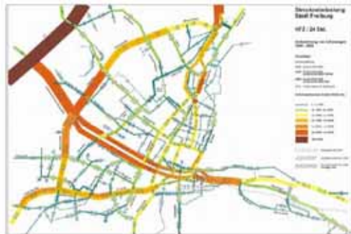
Abb. 106: Streckenbelastungskarten machen die Bewertung der Durchgängigkeit von Fuß- und Radwegen entlang der Gewässer intersubjektiv nachvollziehbar (Belastungsplan Stadt Freiburg, Tiefbauamt, 2002)
