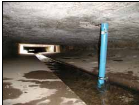
Abb. 31: Drucksonde im Glasbach zur Messung von Abflussereignissen für die Fluss-Einzugsgebiets-Modellierung (Bild: EGGER 2003)
