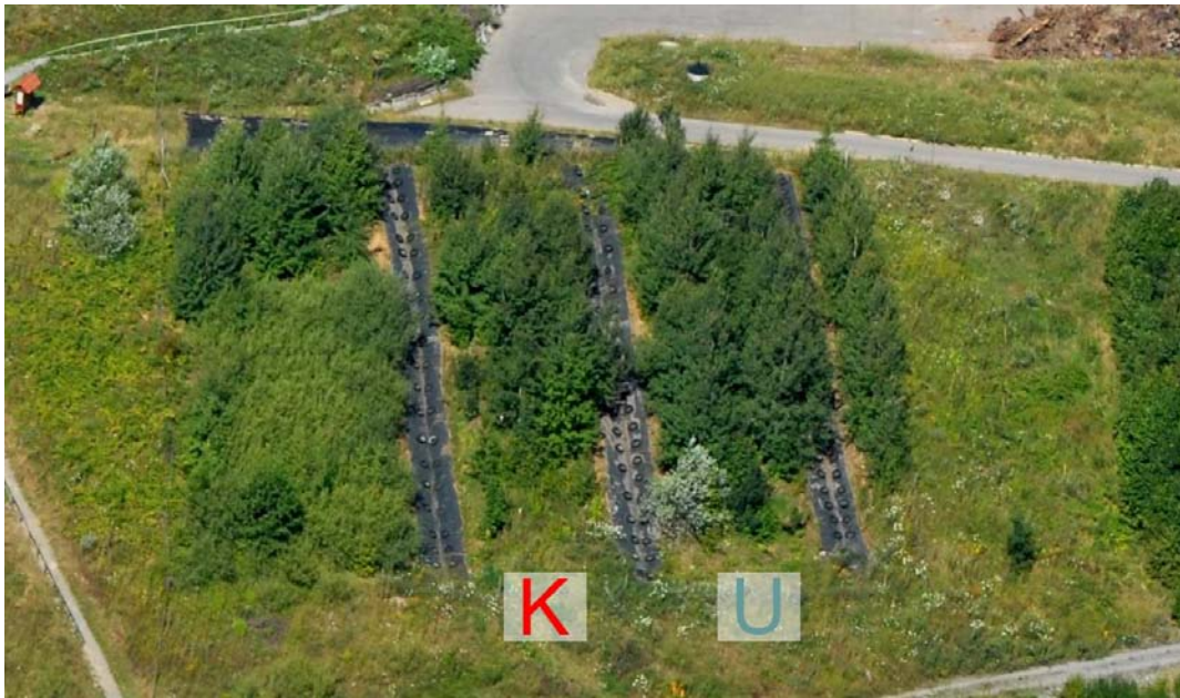
Abbildung 3: Luftaufnahme der Leonberger Testfelder im Sommer 2009; links Feld mit Buschlagen, Mitte: Lysimeterfeld K (Boden verdichtet), rechts: Lysimeterfeld U (Boden unverdichtet)
