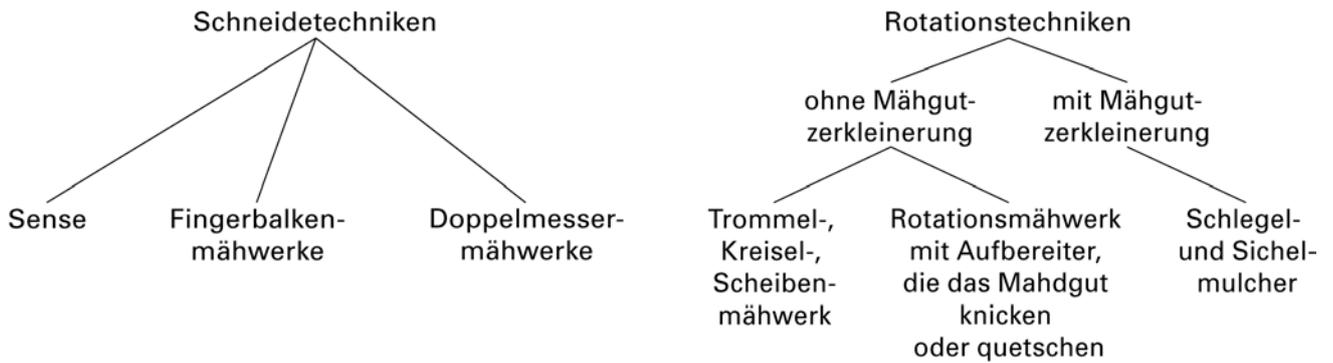
Abb. 2: Schematische Gliederung üblicher Mähetechniken anhand der Funktionsweisen.
